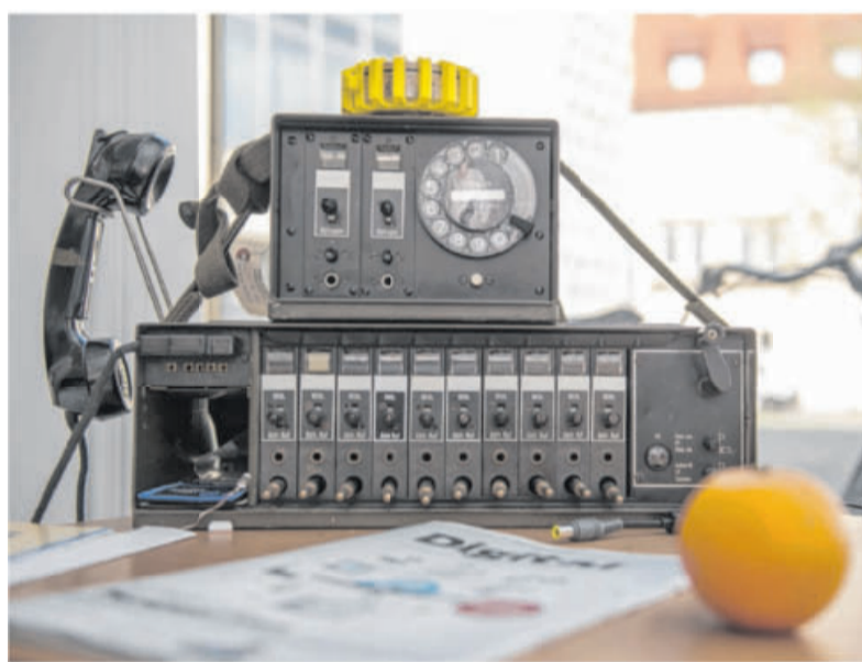
16 000 DM hat der Feldfernsprecher der Bundeswehr 1960 gekostet. Heute kommuniziert er mit IP-Telefonen im Haus.
